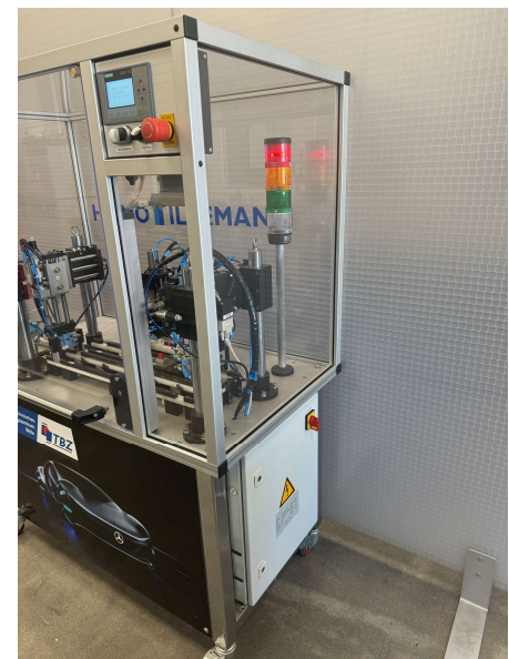
[Bild 2: Einhausung und neue Platzierung vom Schaltschrank]
